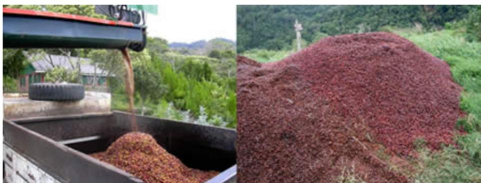
La planta de tratamiento sirve para descontaminar el agua del proceso del café. Esto se logra primeramente separando la pulpa ya que esta lleva muchos azúcares y contamina altamente, además es un producto un poco grande para desintegrarse fácilmente, por lo que primero la separamos, luego esta pulpa se utiliza para la elaboración de humus por medio de lombrices *Eisenia Foetida*. Con esto se elimina una gran parte de la contaminación.
